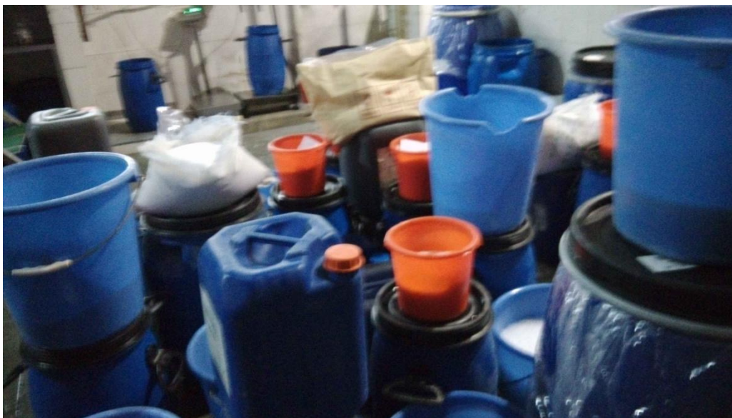
写真 11：化学物質は単に積み上げられているのみで、適切に保管されていない。
