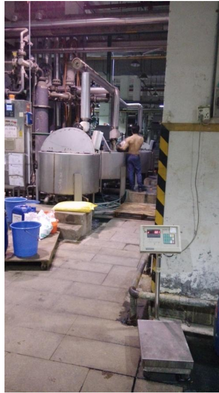
写真6：上半身裸の労働者が、染料をタンクに入れている。高温のタンクには事故防止対策は取られておらず、労働者も事故防止装備をつけていない。
