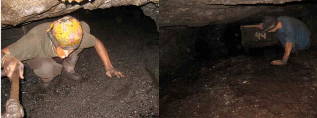
採掘労働者は、小型のツルハシと石炭を積載する荷車を持って水平坑に入り、穴の先端で採掘作業を行う。荷車が満杯になるだけの石炭が採掘できたら、それを縦穴の底まで引っ張って来る。縦穴の底から地上に石炭を運び出すクレーンがある炭鉱では、クレーンで地上に揚げる鉄製の荷箱にスコップで積み替える。クレーンがない炭鉱では、竹を編んで作られた籠に石炭を入れて背負い、階段を使って人力で地上に揚げる。
